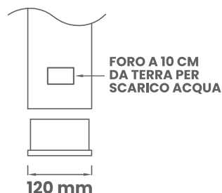
PIASTRA DI BASE TIPO C *: piantone ad innesto con piastra a scomparsa.
